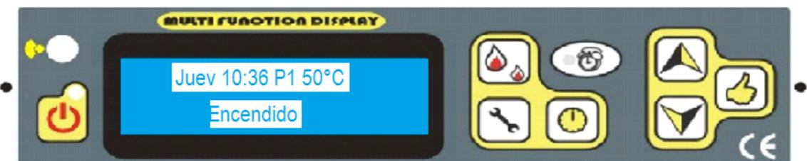
Al iniciar la primera fase de encendido aparece el mensaje "ALIMENTACIÓN". En esta fase se llevan a cabo las operaciones de verificación de chimenea y los pellets son cargados en su vasija. En la siguiente fase la pantalla muestra "Encendido" (Lighting), comenzando la etapa de alimentación. Este estado se mantendrá hasta que la temperatura no exceda el umbral planificado.
