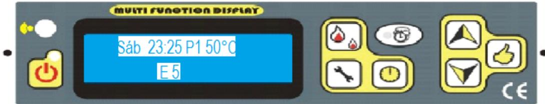
Indica que puede haber problemas con el interruptor de vacío, por ejemplo que una puerta no esté bien cerrada, el ventilador de combustión no está trabajando, hay una fuga en el calefactor o hay algún bloqueo en la tubería de extracción de gases, etc.
