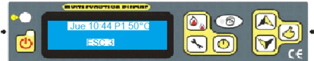
Significa que el sensor de temperatura 3 (sensor para testear la temperatura del ambiente y que está ubicado en la parte posterior del panel) está en corto circuito.
