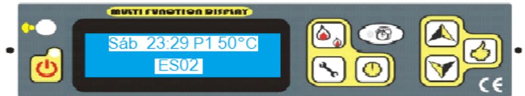
Significa que el sensor de temperatura 2 está en circuito abierto
